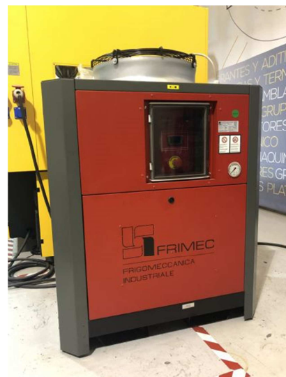
Grupo refrigeración agua 20,9 Kw. 20.000 frig/h.
